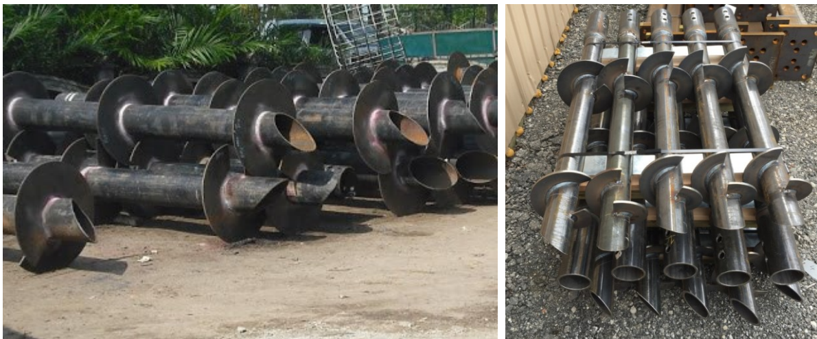
1. ábra Cölöpcsúcs és csavartányérok elhelyezése
